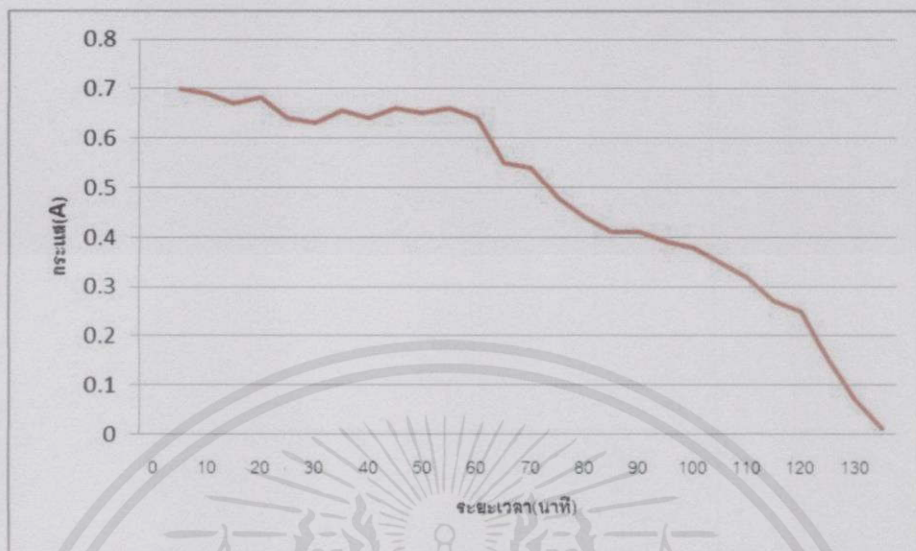
รูปที่ 4.8 กราฟความสัมพันธ์ระหว่างกระแสที่เข้าแบตเตอรี่ (A) กับระยะเวลาในการชาร์จ (นาที) โดยใช้วงจรชาร์จพลังงานจากเซลล์แสงอาทิตย์
