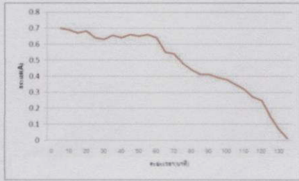
รูปที่ 4.3 กราฟกระแสการชาร์จด้วยวงจรชาร์จพลังงานไฟฟ้าจากแสงอาทิตย์
