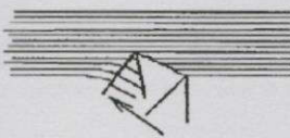
รูปที่ 2.35 แสดงลักษณะการตัดแบบ Scraping cut
