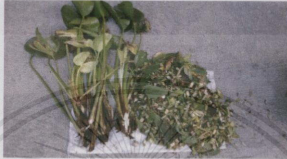
รูปที่ 4.10 แสดงลักษณะการหั่นย่อยผักตบชวาที่ขนาด 3 เซนติเมตร ที่ความเร็วรอบมอเตอร์ 820 รอบต่อนาที
