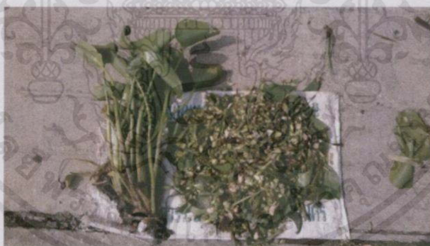
รูปที่ 4.5 แสดงลักษณะการหั่นย่อยผักตบชวาที่ขนาด 1 เซนติเมตร ที่ความเร็วรอบมอเตอร์ 820 รอบต่อนาที
