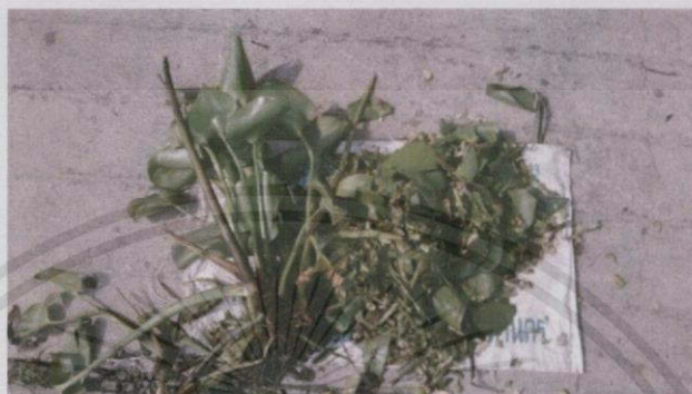
รูปที่ 4.2 แสดงลักษณะการหั่นย่อยผักตบชวาที่ขนาด 1 เซนติเมตร ที่ความเร็วรอบมอเตอร์ 591 รอบต่อนาที
