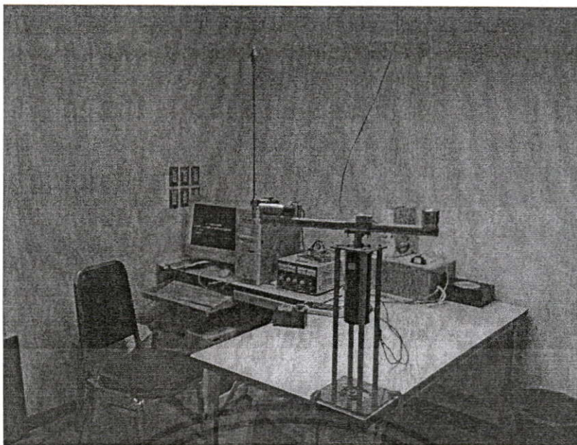
รูปที่ 5.8 ชุดทดลองระบบอินเวอร์ทเพนดูลัมแบบฐานหมุนในห้องปฏิบัติการ
