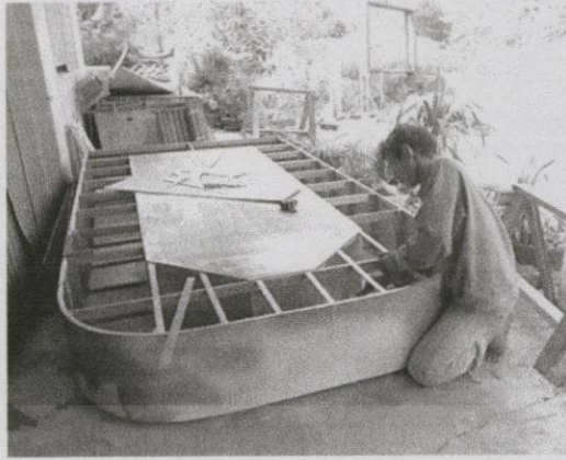
ภาพที่ 3.33 ทำการเคลือบตัวเรือสะเทินน้ำสะเทินบกและสมานรอยต่อ
