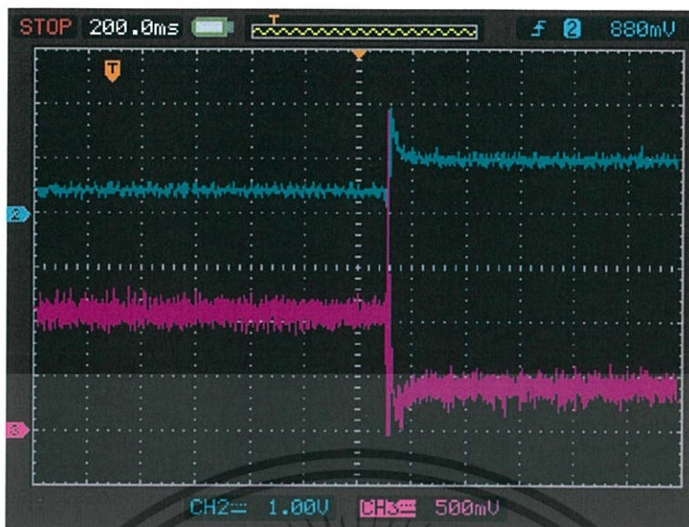
รูปที่ 4.22 การเปลี่ยนแปลงของความถี่ เมื่อ load มีความต้องการกำลังไฟฟ้าจริงน้อยลง
