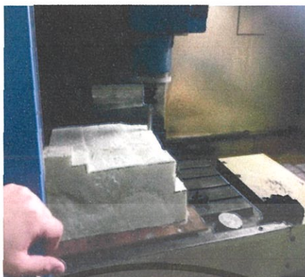
รูปที่ 5.11 โฟมขณะอยู่ในเครื่อง CNC
