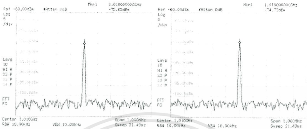
รูปที่ 4.8 ค่ากำลังงานที่วัดได้จาก Spectrum Analyzer ที่ทำให้ระดับแรงดันของเครื่องวัดค่ากำลังงานสัญญาณดาวเทียมเป็น 7 โวลต์ (ซ้าย) และ 7.5 โวลต์ (ขวา)
