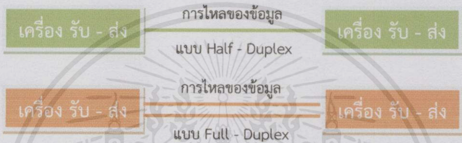
รูปที่ 2.12 การสื่อสารแบบฮาล์ฟดูเพลกซ์ และฟูลดูเพลกซ์
