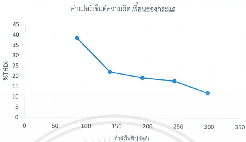
รูปที่ 4.3 กราฟค่าเปอร์เซ็นต์ความผิดเพี้ยนของกระแส (THDi) ที่แรงดันอ้างอิง 200V
