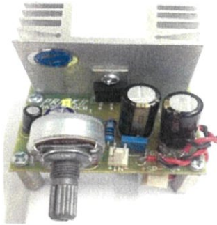
รูปที่ 3.8 ต้นแบบของวงจรขยายกำลัง
