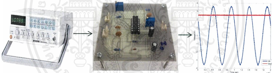
รูปที่ 4.13 ผลการทดลองของวงจร RMS to DC Converter ที่ปฏิบัติจริง ที่ค่าแรงดันขาเข้าขนาด 2.5 โวลต์
