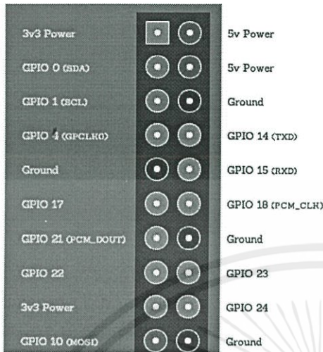
รูปที่ 2.5 การจัดเรียงขา GPIO แบบมาตรฐาน
