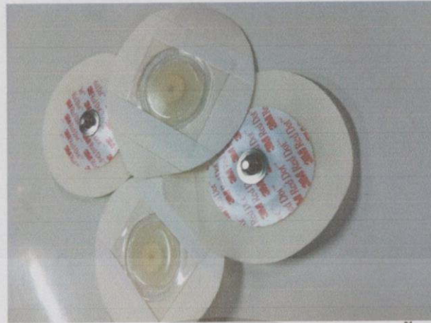
รูปที่ 3.6 อิเล็กโทรดแผ่นที่ทำด้วยโลหะ (ชนิดใช้แล้วทิ้งเลย) สำหรับการตรวจสัญญาณไฟฟ้าหัวใจ
