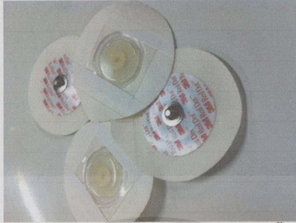
รูปที่ 4.2 อิเล็กโทรดแผ่นที่ทำด้วยโลหะ (ชนิดใช้แล้วทิ้งเลย) สำหรับการตรวจสัญญาณไฟฟ้าหัวใจ
