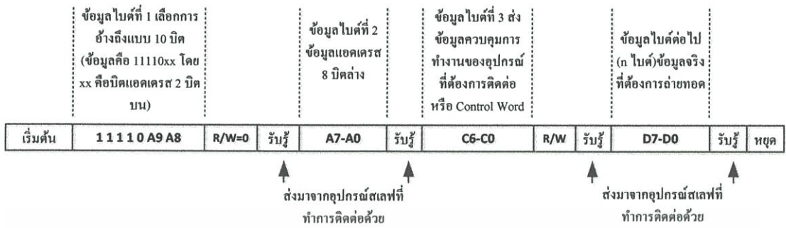
รูปที่ 2.10 แสดงรูปแบบข้อมูลอนุกรมของการอ้างถึงแบบ 10 บิต
