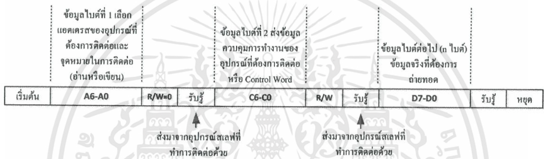
รูปที่ 2.9 ข้อมูลอนุกรมที่เกิดขึ้นในการติดต่อบนบัส I2C ของการอ้างถึงแบบ 7 บิต
