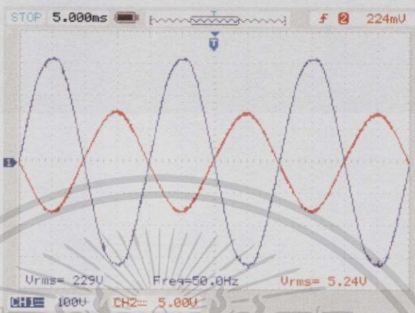
รูปที่ 4.35 คลื่นแรงดันและกระแสในโหมตอินเวอร์เตอร์ที่ 50 Vac, Vdc,ref = 100V, 300W
