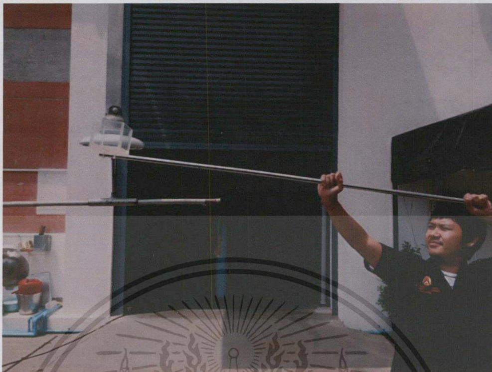
รูปที่ 4.5 การเก็บตัวอย่างน้ำที่ตกกระทบในแนวตั้ง
