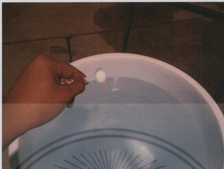
รูปที่ 4.1 การทดสอบผสมน้ำปริมาณ 100 ลิตร กับเกลือปริมาณต่างๆ
