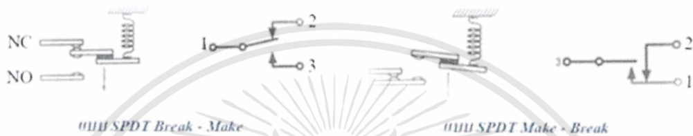
รูปที่ 2.42 หน้าสัมผัสแบบ SPDT แบบ Break – Make และ Make – Break [11]
