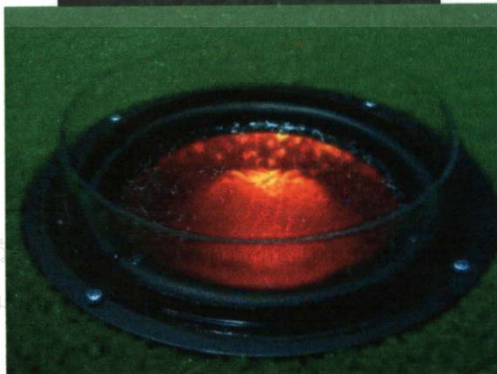
ภาพที่ 4.5 ภาพลำโพงที่ใส่น้ำเมื่อเปิดเสียงผิวน้ำจะเกิดการสั่นไหวไปตามจังหวะของเสียง
