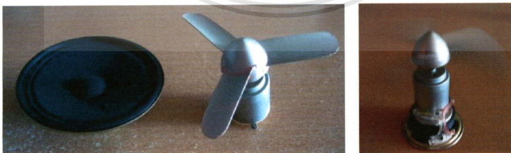
ภาพที่ 4.7 ภาพดอกไม้ไฟกับมอเตอร์ใบพัดนำมายึดติดกัน เมื่อเปิดเสียงมอเตอร์ใบพัดจะทำงาน
