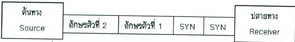
รูปที่ 2.12 ตัวอย่างการใช้อักขระซิง 2 ตัวในการสื่อสารแบบซิงโครนัส
