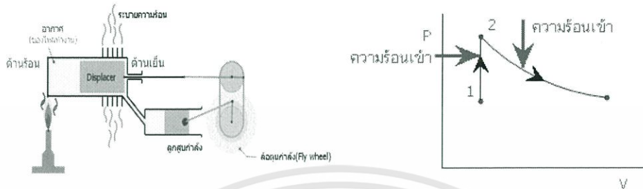
รูปที่ 2.11 การทำงานของเครื่องยนต์สเตอร์ลิงขั้นที่ 2 (รูปซ้าย) และการเปลี่ยนแปลงที่เกิดขึ้นในแผนภูมิความดัน-ปริมาตร (รูปขวา)
