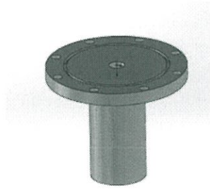
รูปที่ 3.3 ก. ส่วนเสริมของก้านสูบ
