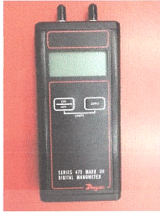
รูปที่ 4.10 เครื่องวัดความดันตกคร่อม, Dwyer 475 Mark III Digital Manometer
