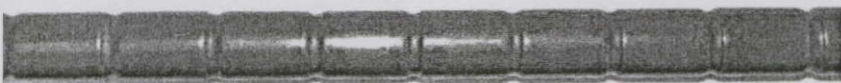
รูปที่ 4.5 แสดงภาพด้านนอกของท่อทองแดงผิวลูกฟูก S=1.5
