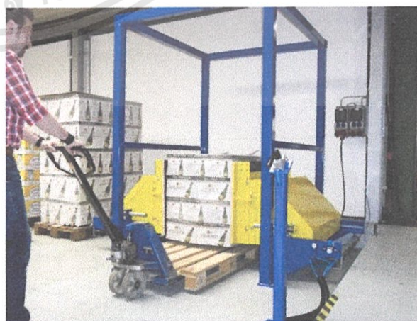
รูปที่ 2 เครื่องเปลี่ยนถ่ายพาเลทที่นำเข้ามาจากต่างประเทศ
