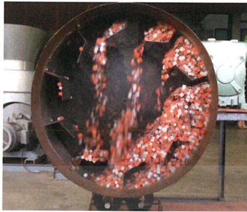
รูปแสดง การตกของแผ่นกั้นมุม 120 องศา 1.8 กิโลกรัม 2 รอบต่อนาที
