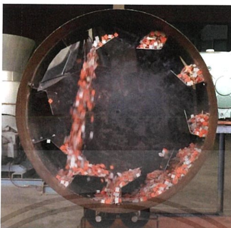
รูปแสดง การตกของแผ่นกั้นมุม 120 องศา 0.6 กิโลกรัม 2 รอบต่อนาที
