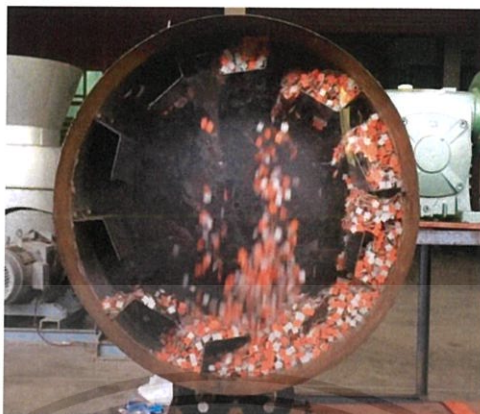
รูปแสดง การตกของแผ่นกั้นมุม 110 องศา 1.2 กิโลกรัม 2 รอบต่อนาที
