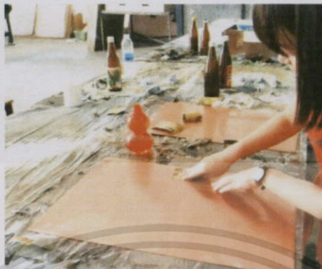
ภาพที่ 3.1 การขัดแม่พิมพ์ทองแดง
