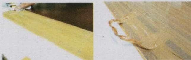
ภาพที่ 3.3 ภาพการติดยูนิเทปบนแม่พิมพ์
