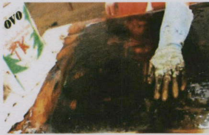
ภาพที่ 3.6 การล้างแม่พิมพ์ทองแดง
