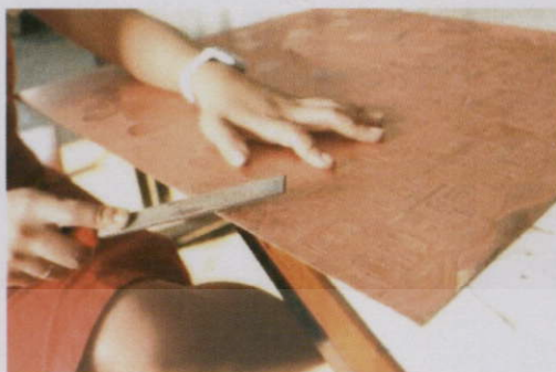
ภาพที่ 3.14 ตะไบมาขัดขอบแม่พิมพ์
