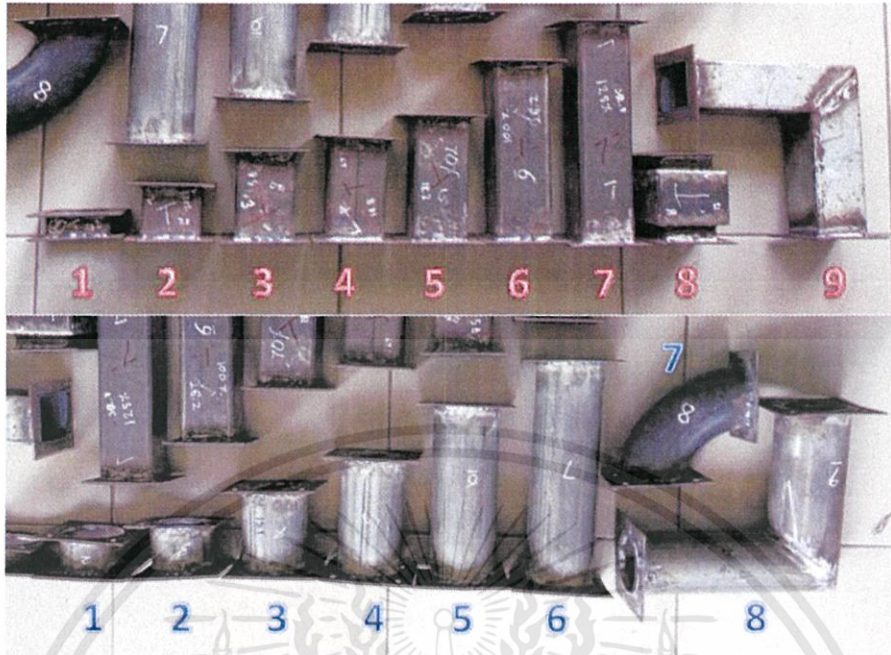
รูปที่ 3.2 แสดงรูปแบบทางออกท่อต่างๆ (บน) ท่อเหลี่ยม (ล่าง) ท่อกลม
