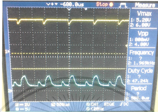
รูปที่ 4.4 กราฟแสดงการวัดที่ทางออกของ Sampling and Hold ก่อนทำการทดลอง red led (CH 1 ) และของ ir led (CH 2 )
