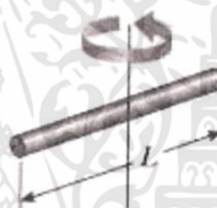
รูปที่ จ.3.2 แท่งทรงกระบอกตันประมาณรูปทรงของใบพัด
