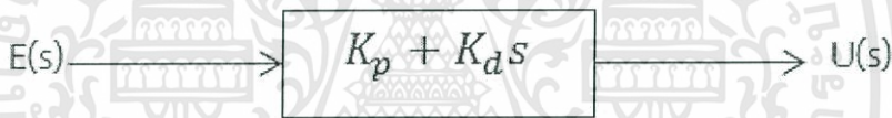
รูปที่ 2.26 ตัวควบคุมแบบสัดส่วนบวกกับตัวควบคุมแบบอนุพันธ์
