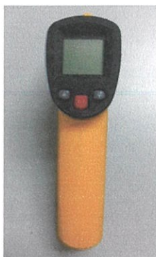
รูปที่ 3.6 เครื่องวัดอุณหภูมิแบบอินฟราเรด
