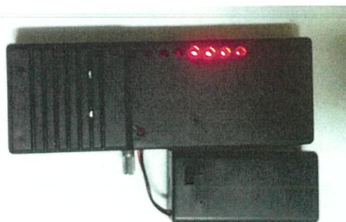
รูปที่ 4.35 ภาพแสดงการทำงานของเครื่องวัดระดับเสียงเมื่อ LED ติด 4 หลอด
