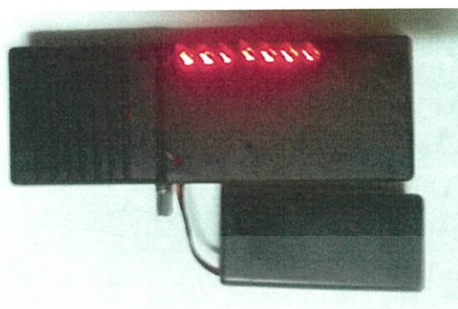
รูปที่ 4.38 ภาพแสดงการทำงานของเครื่องวัดระดับเสียงเมื่อ LED ติด 7 หลอด
