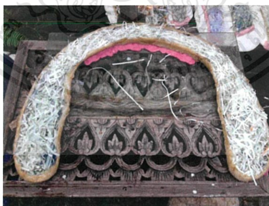
ภาพประกอบที่ 54 : นำกระดาษรีไซเคิลมาใส่ในแบบพิมพ์ที่ทำไว้จนแน่น หลังจากนั้นผสมเรซินกับน้ำยาดิวเร้งในกล่องพลาสติก อัตราเรซิน 1 ลิตร : ดิวเร้ง 1 ฝา (ไม่ควรใส่น้ำยาดิวเร้งมากเพราะจะทำให้เรซินมีฟอง) หลังจากนั้น ให้เทลงในแม่พิมพ์ที่ทำไว้ ปล่อยให้แห้ง
