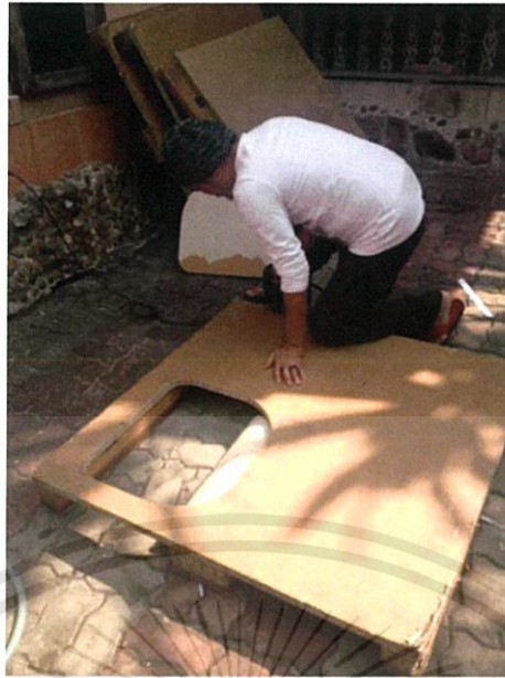
ภาพประกอบที่ 57 : ร่างภาพขนาดแต่ละส่วนเรียบร้อย แล้วจึงใช้เลื่อยไฟฟ้าตัดออกทีละส่วน
