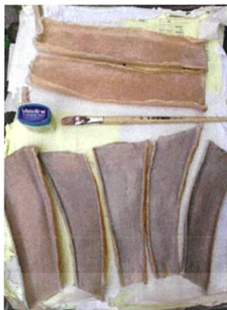
ภาพประกอบที่ 52 : เมื่อแห้งแล้วจะได้แม่พิมพ์ แล้วทาวาสลินข้างในอีกครั้ง เพื่อเตรียมการหล่อเรซิน
