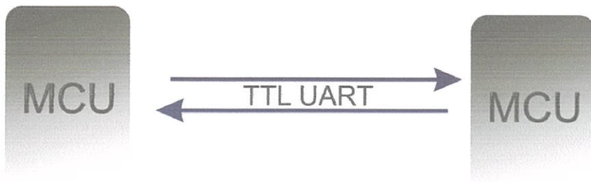
รูปที่ 16 การติดต่อของMCU กับ MCU
