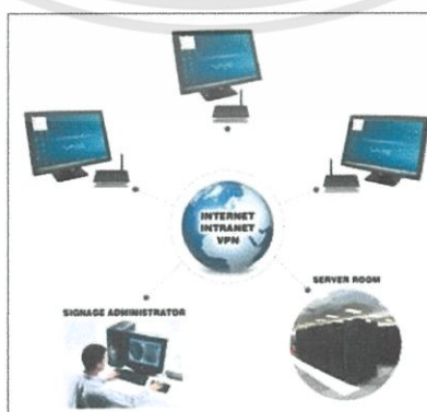
รูปที่ 2.2 ประเภทของอุปกรณ์ที่รองรับการทำงานของสื่อประชาสัมพันธ์ทางจอภาพดิจิทัลแบบ Network Player
