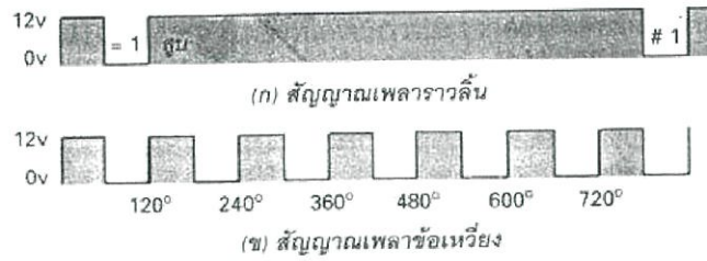
รูปที่ 2.22 แสดงสัญญาณจากตัวตรวจจับตำแหน่งเพลาราวลั่นที่สัมพันธ์
