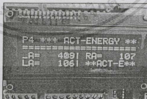
รูปที่ 3.50 แสดงค่ากำลังไฟฟ้า เฟส A ที่โหลด 100,200,300,400 Watt
