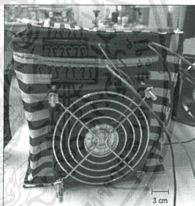
รูปที่ 4.12 แบบ B ทดลองในกล่องเก็บความเย็น
