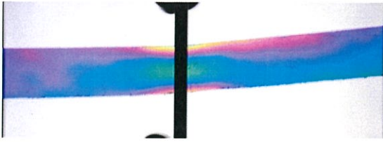
รูปที่ 4.1(ก.) รีวของชิ้นงานที่เกิดจากการ ใส่แรงลงไป 9.81 นิวตัน
