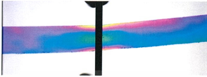
รูปที่ 4.2(ก.) รูปรีวิวของชิ้นงานที่เกิดจากการใส่แรงลงไป 9.81 นิวตัน ที่เข้าโปรแกรมตรวจสอบความเค้น
