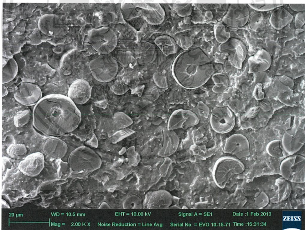
รูปที่ 4.40 SEM กำลังขยาย 2000 เท่า แสดงลักษณะพื้นฐานวิถยาระหว่าง PBS/HBS/ CaCO 3 40 php
