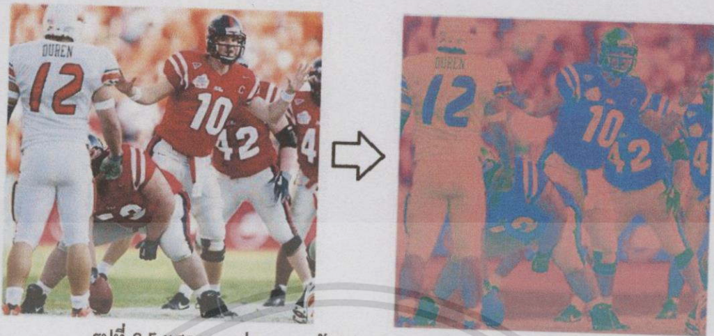
รูปที่ 2.5 แสดงภาพก่อนและหลังการแปลงภาพสีจาก RGB เป็น YCbCr
