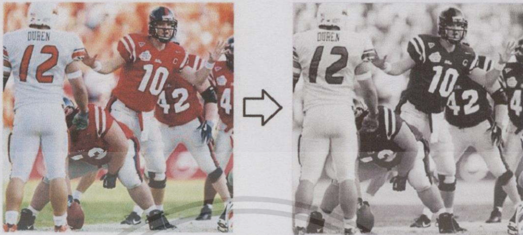
รูปที่ 2.6 แสดงภาพก่อนและหลังการแปลงภาพสีจาก RGB เป็นระดับสีเทา
