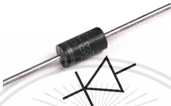
รูปที่ 2.15 ตัวไดโอดและสัญลักษณ์ที่ใช้แทนในวงจร
