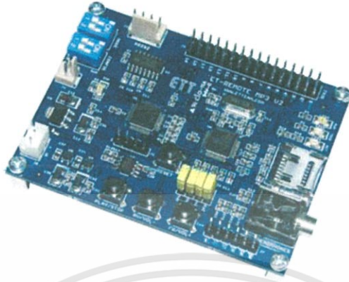
รูปที่ 4 บอร์ดถอดรหัสเสียง (ET-MINI MP3)
