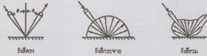
รูปที่ 2.3 ลักษณะของการสะท้อนรังสีจากผิววัตถุแบบต่างๆ
