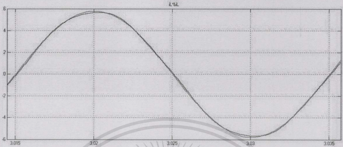
รูปที่ 3.35 กรณีที่ 3 เปรียบเทียบค่ากระแสค่าสั่ง(สีดำ)และค่ากระแสไฟฟ้าที่ป้อนกลับ(สีชมพู)
