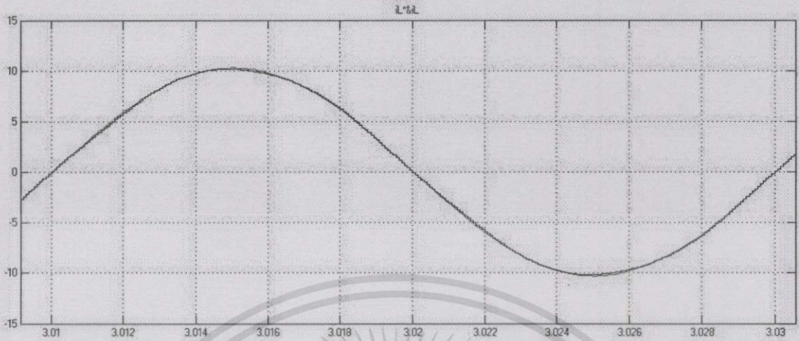
รูปที่ 3.33 กรณีที่ 1 เปรียบเทียบค่ากระแสคำสั่ง(สีดำ)และค่ากระแสไฟฟ้าที่ป้อนกลับ(สีชมพู)
