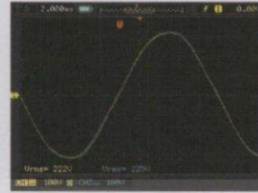
รูปที่ 6 แรงดันขาออกจากอินเวอร์เตอร์เทียบกับแรงดันของระบบ
