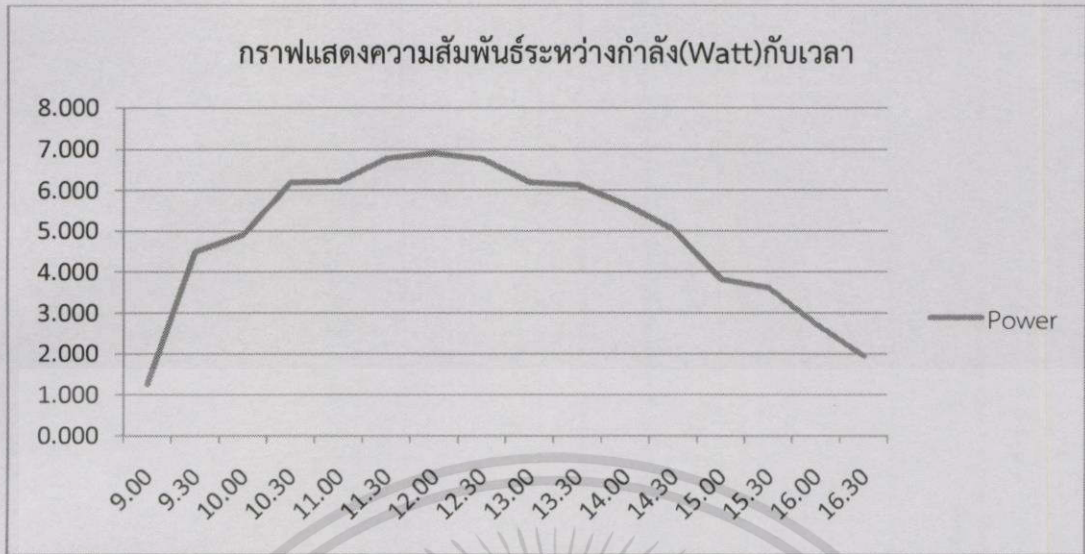
รูปที่ 4.1.7 กราฟแสดงความสัมพันธ์ระหว่างกำลัง(Watt)กับเวลาก่อนเข้าแบตเตอรี่
