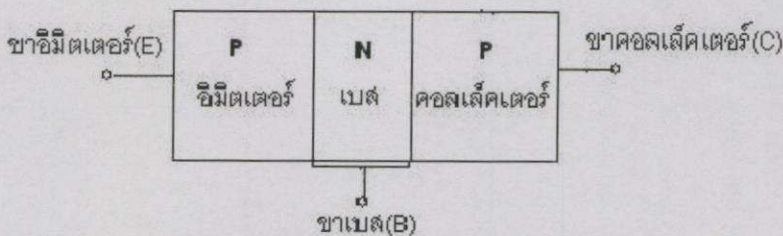
รูปที่ 2.4.2 โครงสร้างทรานซิสเตอร์ชนิด PNP
