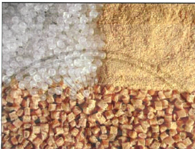
รูปที่ 2.1 องค์ประกอบหลักของ WPC (บนซ้าย) PE (บนขวา) ผงไม้ และ (ล่าง) เม็ดคอมพาวด์ (เป็นสุภา ปีติรักษสกุล, 2551)
