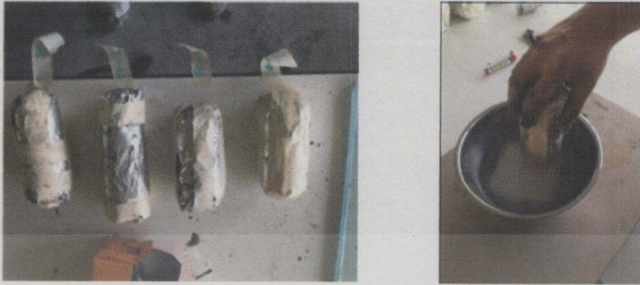
รูปที่ 3.12 การเก็บรักษาตัวอย่างดินด้วยการห่อฟรอยด์และชุบพาราฟิน
