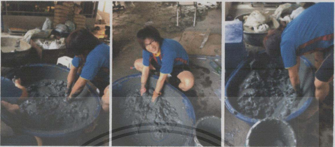
รูปที่ 3.7 ทำการผสมน้ำในดินที่ 1.5 เท่าของ Liquid Limit เพื่อให้ดินเหนียวมีการไหลได้ดี
