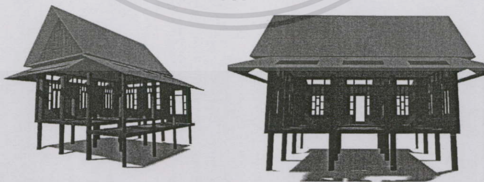
รูปที่ 8.12 แสดงการกระจายภายในเรือนจากการเพิ่มช่องแสงบนชายคา
