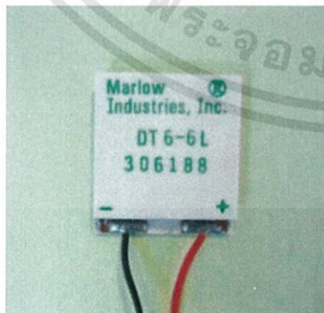
รูปที่ 13 เทอร์โมอิเล็กทริก DT6-6L 82VDC 46W(C)
