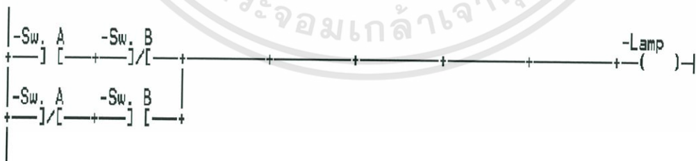
รูปที่ 2.10 LD (Ladder diagram) [1]
