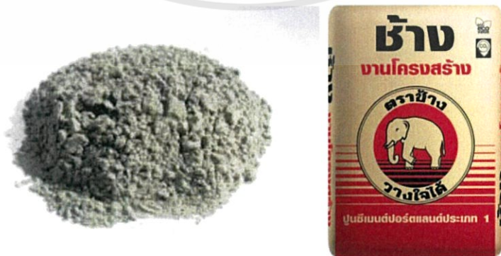
รูปที่ 3.3 ปูนซีเมนต์พอร์ตแลนด์ประเภทที่ 1
